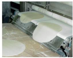
Bandas de PU o algodón/poliéster para el transporte de masa. Deben ser mates, "FF", o con ligero grabado con el fin de permitir una buena transferencia.
