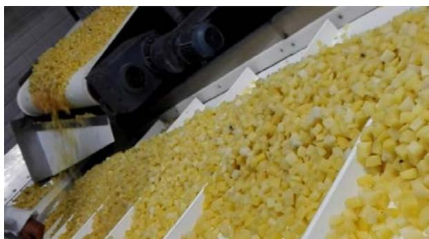
Banda CLINA S 20UFMT con perfiles transversales transportando patatas.
