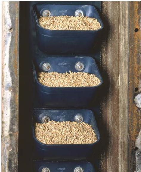
Los componentes más importantes de un elevador son los cangilones, que deben poseer características acordes con el material transportado y la forma adecuada para realizar correctamente la descarga:
