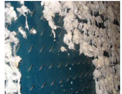
Detalle de la telera que recoge y abre la lana transportada por la acompañadora.
