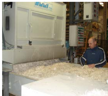
Separación manual de lana defectuosa.
