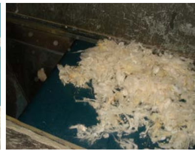
Bandas que recogen los restos que caen del rodillo expulsor por la parte posterior.
